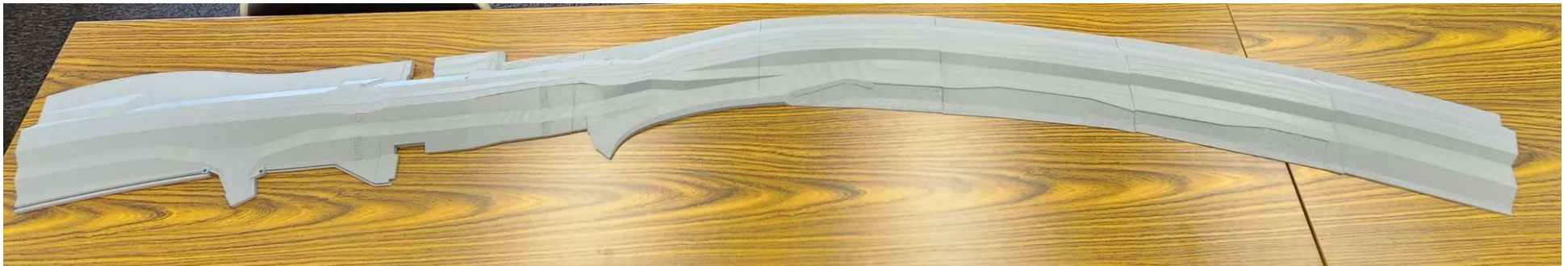
3次元モデルを模型にて作成(実寸に対し1/200の縮尺で作成)
